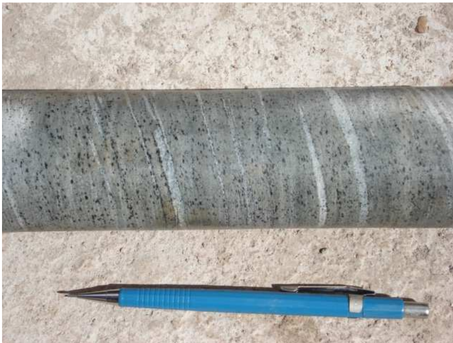
Figura 12 - Detalhe de magnetita-clorita-fengita filito recuperado em sondagem rotativa durante os estudos para a implantação da PCH Colinas (baixo curso do rio Tocantinzinho).
