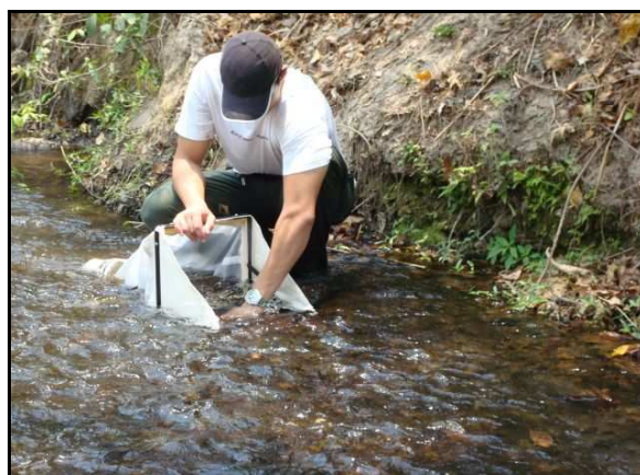
Figura 21 – Coleta de zoobentos com amostrador de “Surber”, através do revolvimento do substrato no córrego Toconhão (Ponto P02).
