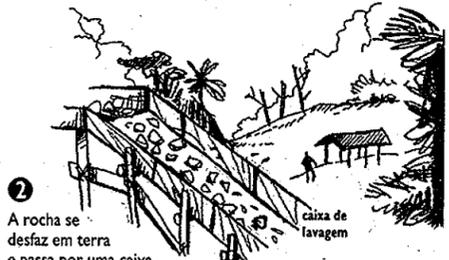
2 A rocha se desfaz em terra e passa por uma caixa de lavagem. Em seguida, aplica-se mercúrio para concentrar o ouro e o metal pesado numa pedra, chamada amálgama. Depois dessa etapa, a pedra passa a concentrar apenas ouro e mercúrio
