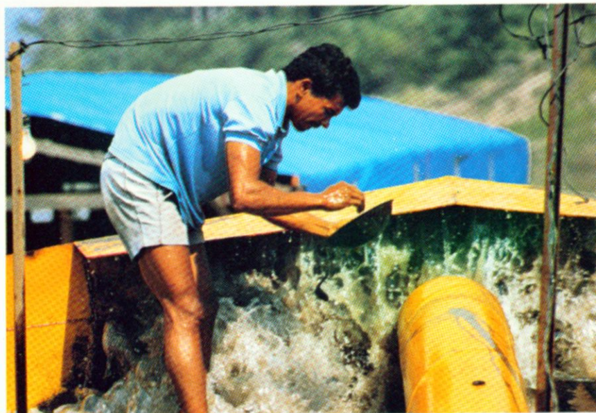
Um sinal do mergulhador, por meio de alguns trancos na mangueira de sucção, determina a hora de o pessoal da draga "cuiar". Se há partículas de ouro, o lugar é bom.
