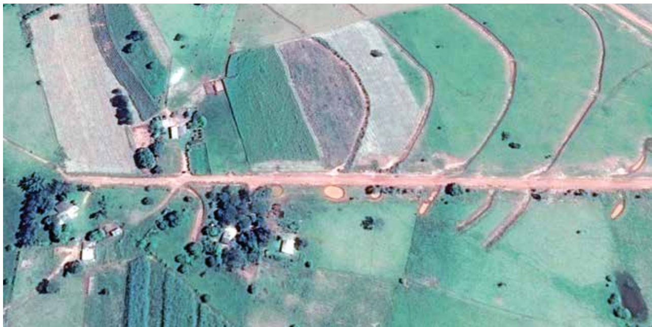
Foto 2.9 - Barraginhas para contenção de água de chuva.
