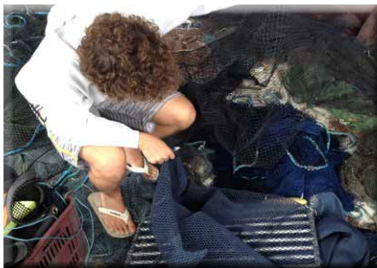
Figura 22: Dispositivo de grelha sendo acoplado à rede de arrasto.
