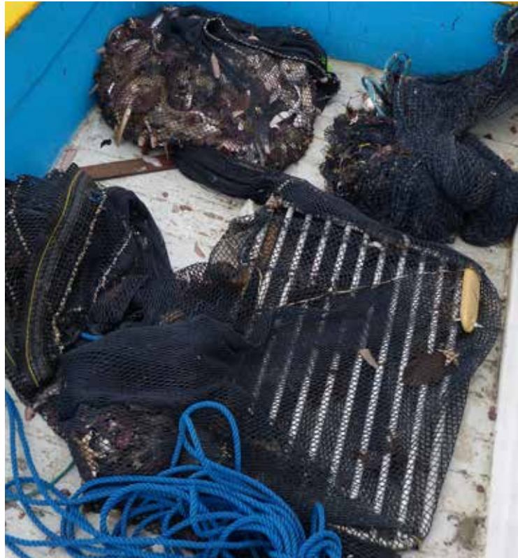
Figura 21: Dispositivos em teste para redução da captura incidental da fauna acompanhante na pesca artesanal de arrasto de camarão na APA do Anhatomirim
