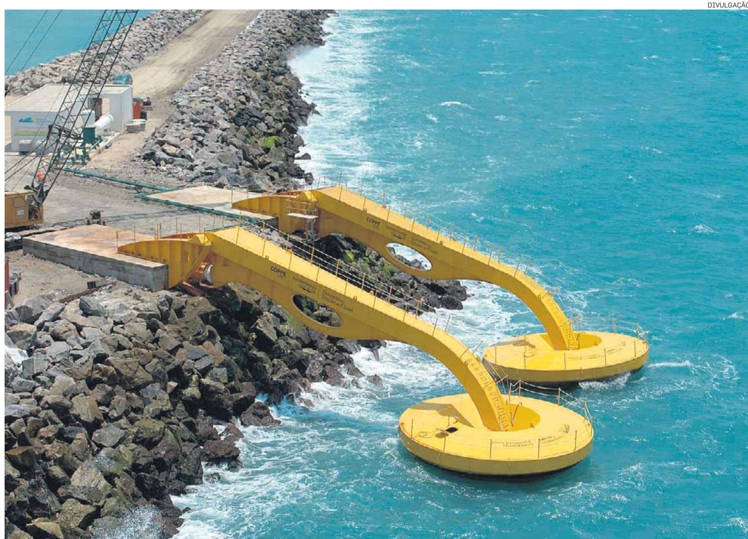
Natureza. Ondas movem braços mecânicos flutuantes que ativam bombas hidráulicas: energia para abastecer porto
