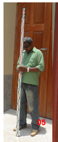
Fotos 02, 03, 04 e 05: Estação Total Topcon (2), Antena do Receptor GPS ASTECH (3), Bastão/Prisma (4) e Mira Falante (5).
