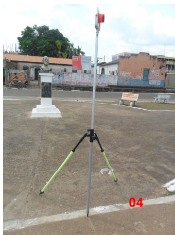
Fotos 02, 03, 04 e 05: Estação Total Topcon (2), Antena do Receptor GPS ASTECH (3), Bastão/Prisma (4) e Mira Falante (5).
