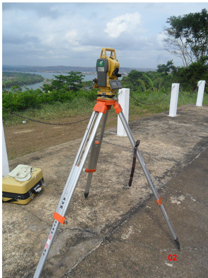
Fotos 02, 03, 04 e 05: Estação Total Topcon (2), Antena do Receptor GPS ASTECH (3), Bastão/Prisma (4) e Mira Falante (5).
