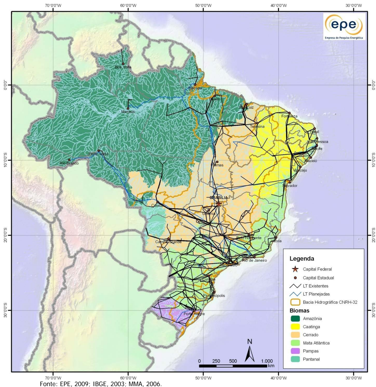
Figura 25 – Sistema de transmissão – existente e planejado
