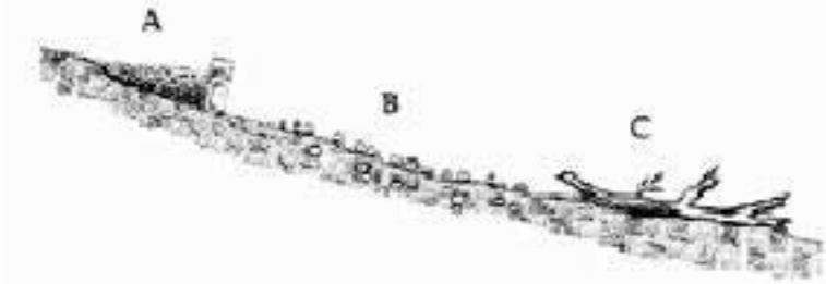
Figura 1. Señales de erosión laminar
