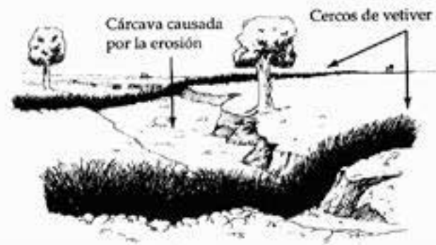
Figura 43. Estabilización de cárcavas
