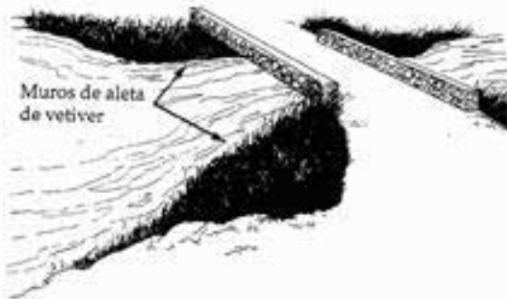
Figura 44. Protección de puentes
