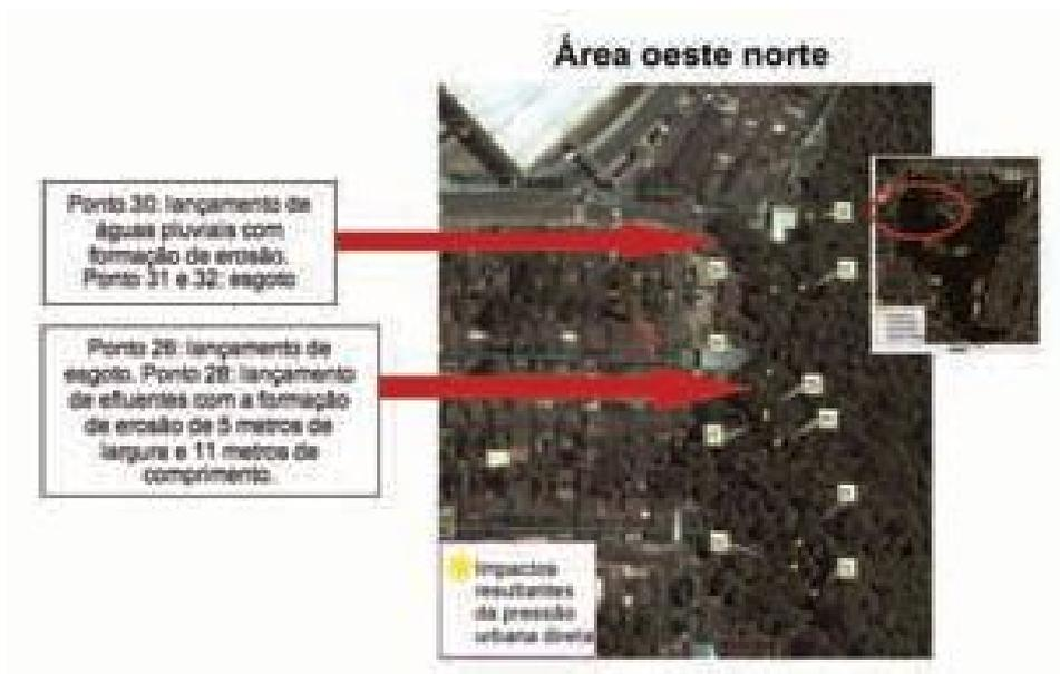
Figura 30: Localização de águas pluviais, esgoto e erosão área oeste norte.
