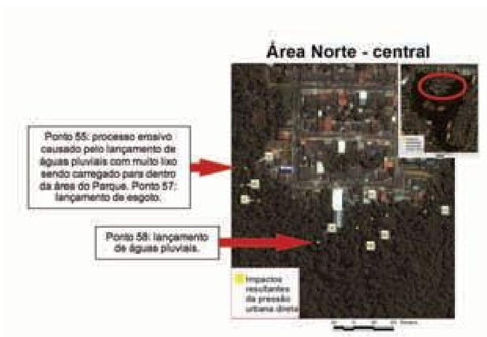
Figura 32: Localização de processo erosivo e águas pluviais área norte-central.
