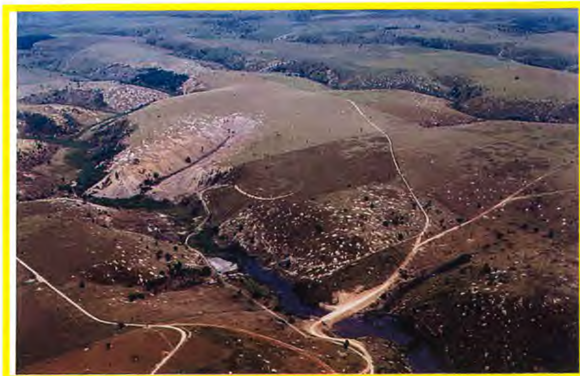
Foto 19 - Situação de exploração dos recursos naturais do município de Pinheiros-ES. Barragens construídas sem monge ou qualquer condição de vazão, completamente irregular e sem mecanismos para evitar o desmoronamento.
