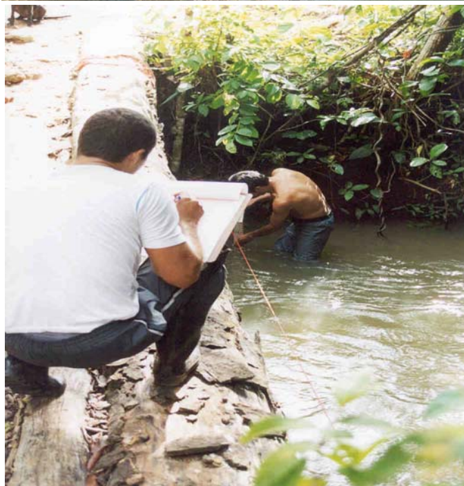
Figura 16: Profissionais do NATURATINS e da DBO ENGENHARIA realizando medições de vazão no ribeirão Lajeado
