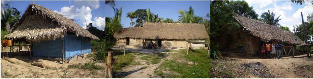
**Figura 2.24.** Casas da RESEX com as paredes construídas de diferentes materiais (começando pela esquerda: aberta com quarto de paredes de tecido; paredes de barro; paredes de palha).
