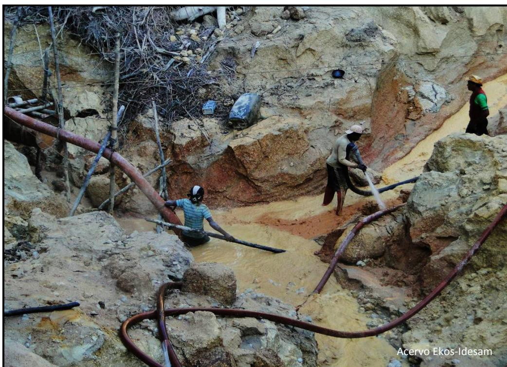
**Figura 6.9:** Garimpo manual com uso de “bico-jato”.<sup>29</sup>
