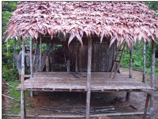
Figura 74. Telhado de palha de ubim (CANALEZ, 2007)
